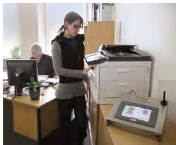
Abb. 6: Typischer Einsatz des Fidas® mobile bei Innenraumluftqualitätsmessungen
