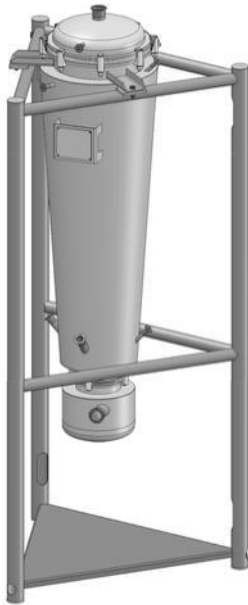
Abb. 3: CAD-Zeichnung des hochskalierten Reaktors
